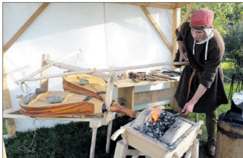
Luft und Feuer: dank der Wippe blasen die beiden Blasbälge ununterbrochen in die Glut.
