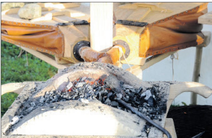
Beindruckend einfach: Blasbälge aus Holz und Ziegenleder. Die glühende Kohle liegt in Lehm vom Stierenberg.
