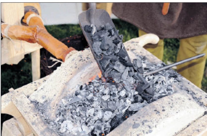
Heizen bis auf 1300 Grad: Holzkohle muss nachgelegt werden.
