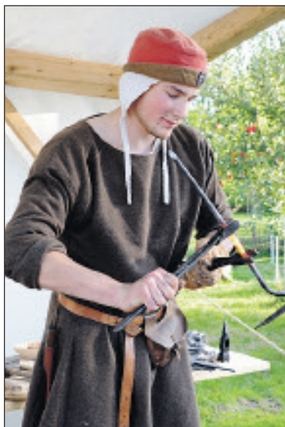
Heisses Eisen: der Schaft eines Schürhakens wird zur Verzierung verdreht.
