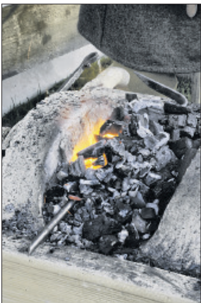
Heisses Eisen: der Schaft eines Schürhakens wird zur Verzierung verdreht.
